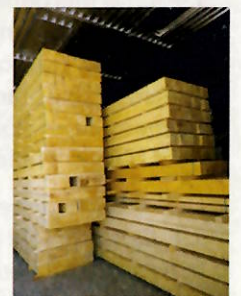
Séchage en cours de poteaux en sapin.
